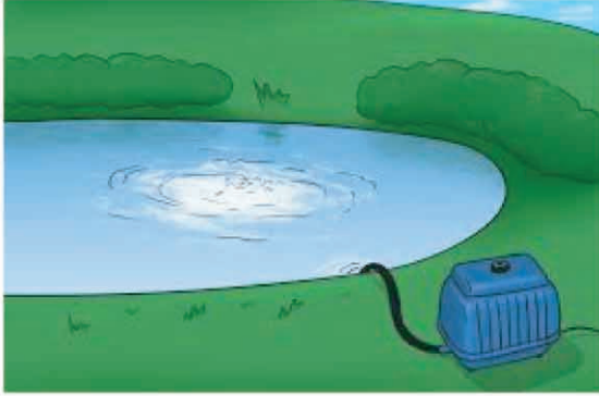
চিত্র ২ঃ মাছ চাষের পুকুরে এ্যারেশনের মাধ্যমে অক্সিজেন সরবরাহকরণ
